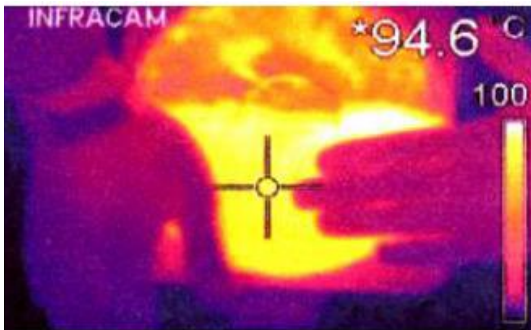
Παρουσίαση θερμογραφίας ηλεκτρικής εστίας στους 94.6 °C σε επαφή με γυμνό χέρι
